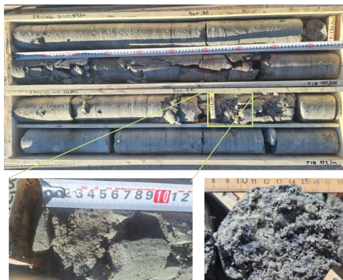
Abbildung 3. Die gewonnenen Bohrkern zeigen feinkörnigen Sandstein in 172 m Tiefe (oben und links). Sulfatkörner in Tonstein-Schluffstein in 50 m Tiefe
